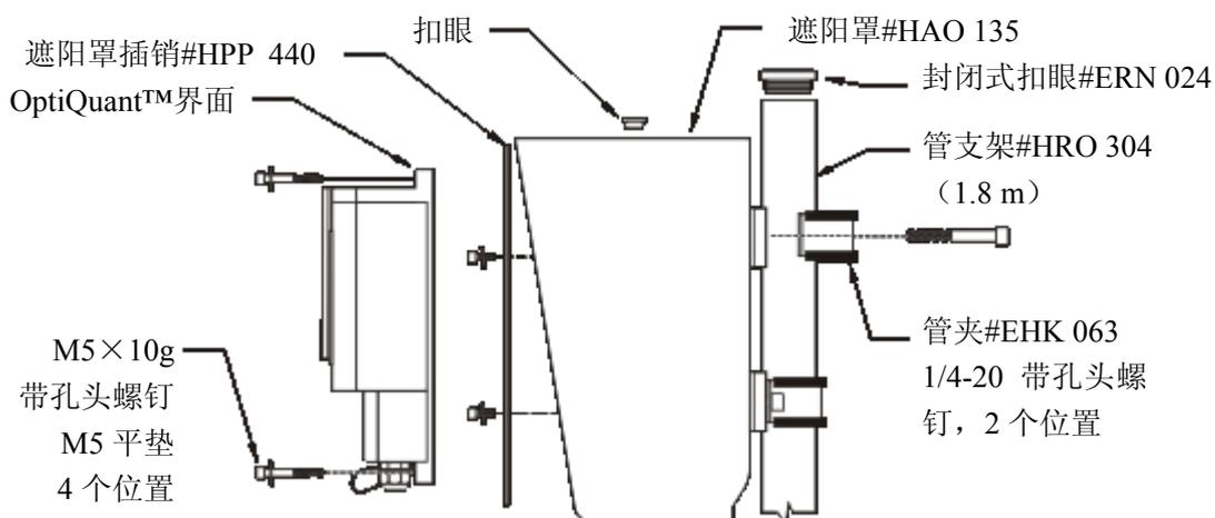
图 12 安装固定控制器的硬件
