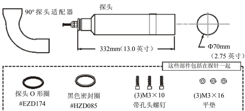
图 17 安装探头固定硬件
