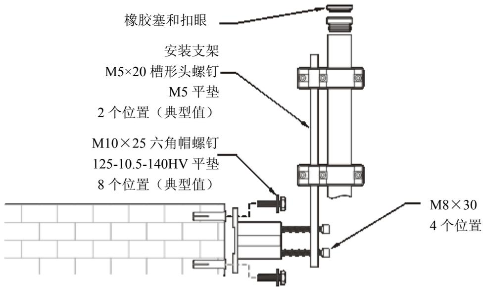
图 18 使用固定点安装包来安放探头
